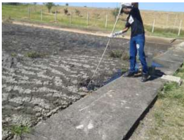
Figura 1. Coleta do contaminante de lodo de esgoto gerado na Estação de Tratamento de Esgotos Samambaia/Melchior, no Distrito Federal.
