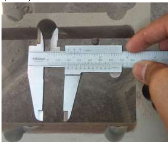
Figura 9 – Forma adaptada para atender aos pré-requisitos de área de percolação conforme a norma ABNT NBR 16416 (ABNT, 2015).
