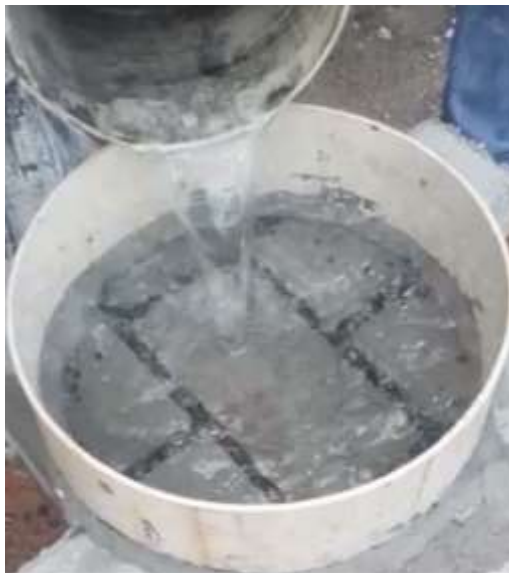
Figura 13 – Amostras moldadas de acordo com as normas NBR 16416 (ABNT, 2015) e NBR 9781 (ABNT, 2013).
