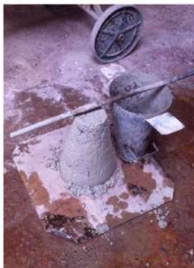
Figura 3.1 – Teste de Abatimento do concreto com o CPB 40 (Traço 03).
