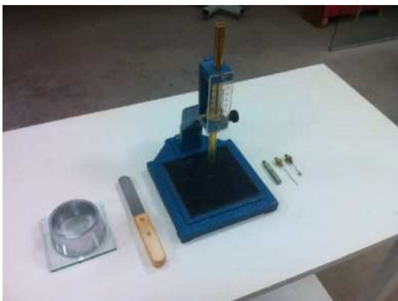
Figura 2.1 - Aparelho de Vicat, agulhas de Vicat, espátula metálica, molde de tronco cônico, placa de vidro.
