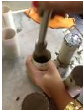
Figura 4- Moldagem dos corpos de prova
