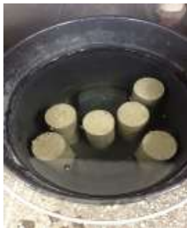
Figura 6- Processo de cura
