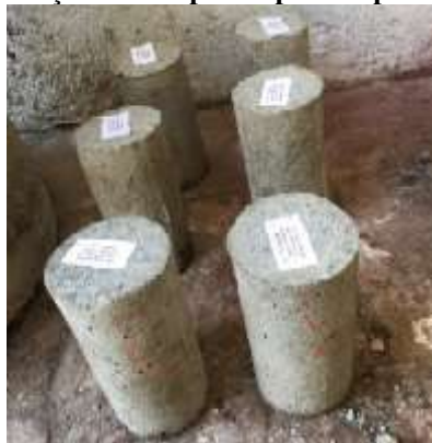
Figura 3 - Identificação dos corpos de prova tipo C1 com giz de cera
