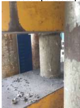
Figura 5 – Ensaio de ruptura do corpo de prova
