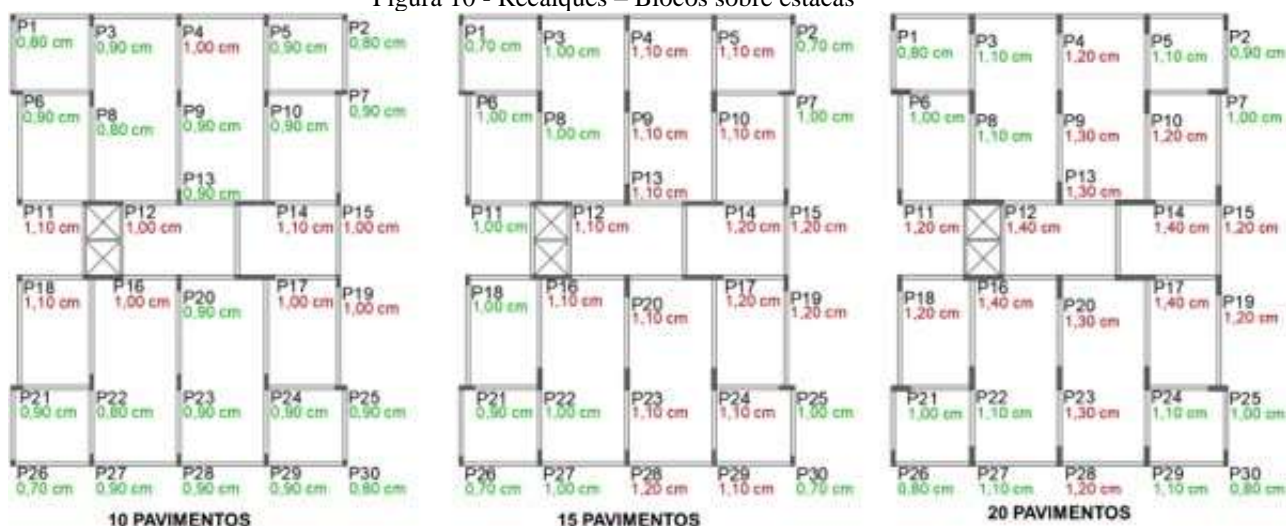
Figura 10 - Recalques – Blocos sobre estacas
