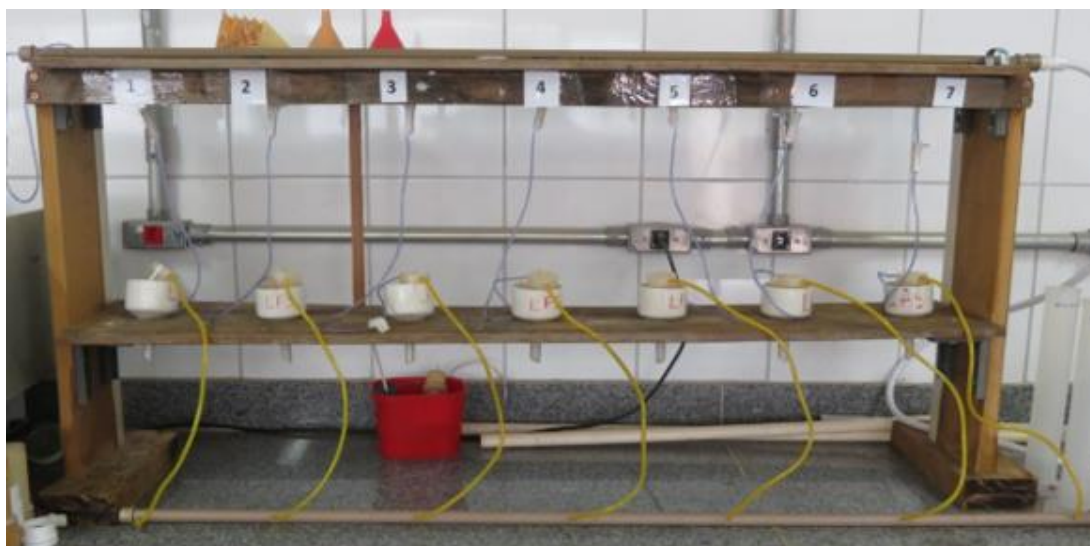
Figura.5. Módulo do Permeâmetro de Carga Constante construída para determinação da condutividade hidráulica do solo saturado das Bacias de retenção em estradas não pavimentadas.
